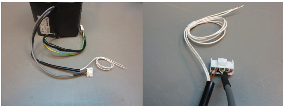
Εικόνα 3: Κύριος Κινητήρας VF με Θερμικό Αισθητήρα και Encoder.
